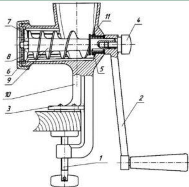
1 - винт; 2 - рукоятка; 3 - опора; 4 – винт; 5 – втулка;.6 – гайка зажимная; 7 – нож;
